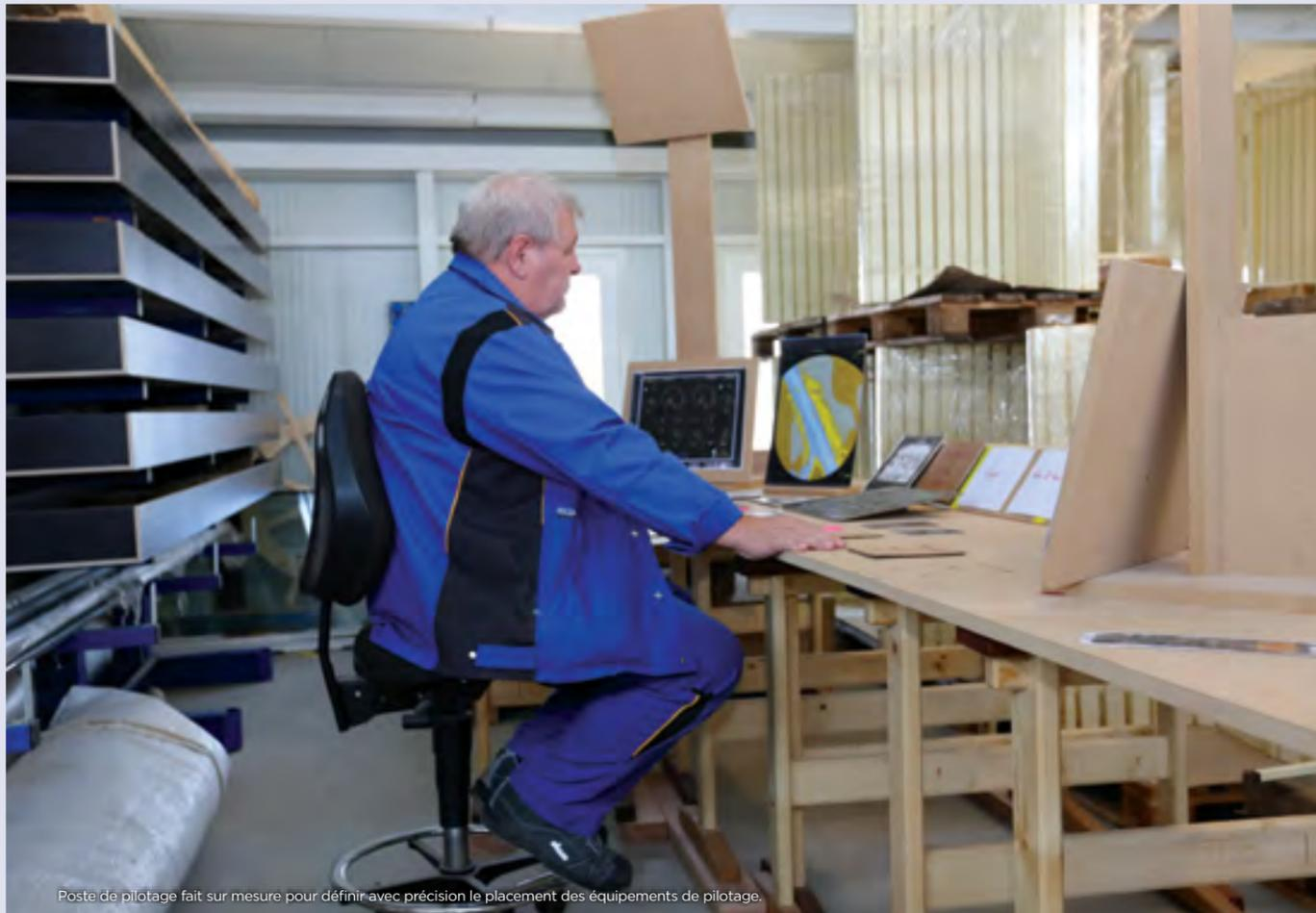
Poste de pilotage fait sur mesure pour définir avec précision le placement des équipements de pilotage.
